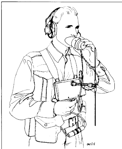
Fig. 4. De S-phone in gebruik. De "silent microphone" sluit de mond geheel af.
